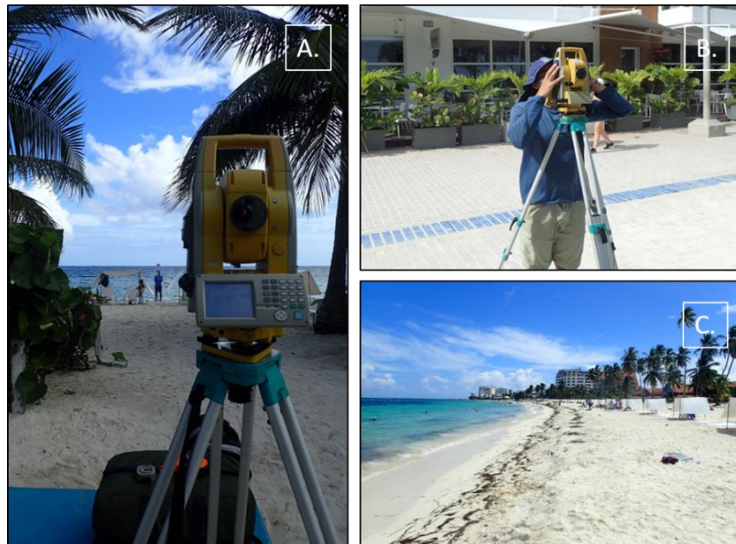
Figura 4.5 Levantamiento de perfiles de playa y línea de costa. A y B) Levantamiento de perfiles con estación total. C) Estado generalizado de la playa Spratt Bight.
