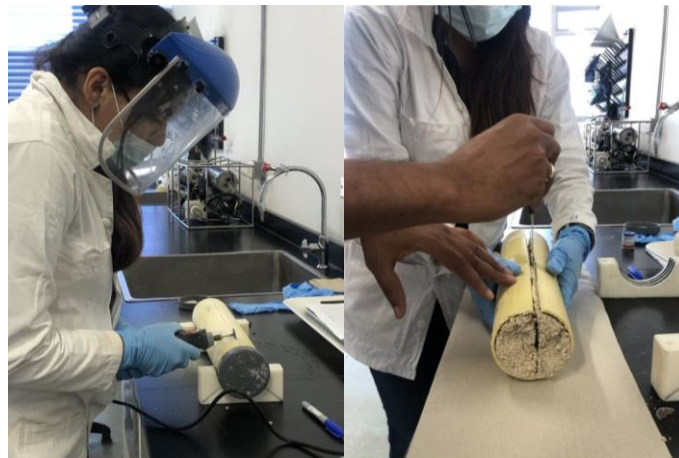
Figura 4.3 Procedimiento de apertura de núcleos en el Laboratorio de Instrumentación Marina -LABIMA.
