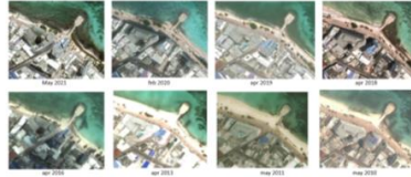
Spratt Bight: patrón erosivo cerca del rompeolas en el lado este de la playa
